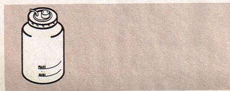
Den Kühlflüssigkeitsstand überprüfen. Das Kühlsystem ist mit einer Frostschutzmischung versehen und hermetisch verschlossen. Jedoch muß kontrolliert werden, ob keine Undichtigkeit besteht. Hierzu den Flüssigkeitsstand im Ausgleichbehälter überprüfen. Er muß sich zwischen den Markierungen „MINI“ und „MAXI“ befinden.
