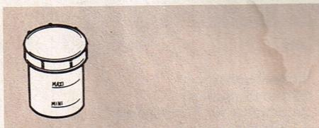
Überprüfen Sie den Bremsflüssigkeitsstand im Ausgleichbehälter.
